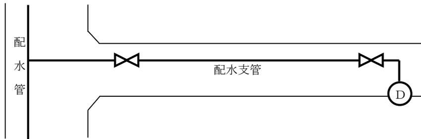
図 5-8 排泥弁の位置（開発等による配水支管設置）
