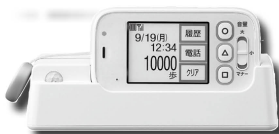
▲ 緊急通報システム端末機器
