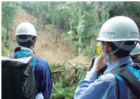
写真－ 5.2.3 レーザー測器を用いて被災規模を計測（溪流調査）
